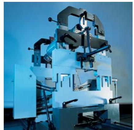
**Paliers HM :** Les paliers étroits et robustes garantissent une rigidité absolue, une grande linéarité et un niveau d'amortissement extrêmement faible. La section intermédiaire des paliers SCHENCK est constituée de dynamomètres rigides. Les capteurs sont placés en dehors des champs de force et sont, par conséquent, insensibles aux chocs.
